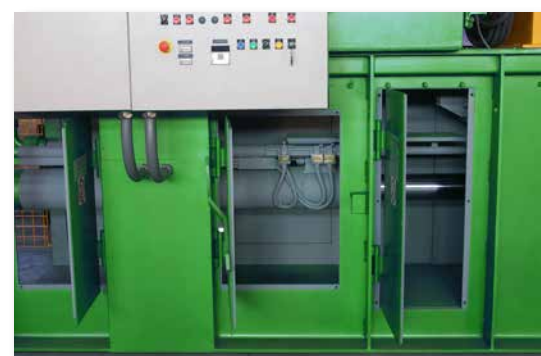
Camera di compattazione di facile accesso per manutenzione e pulizia. Easy access to the compaction chamber for maintenance and cleaning
